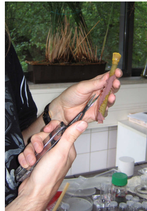
Abbildung 5.2: Das komprimierte Pulver wird dem Gummischlauch entnommen.
