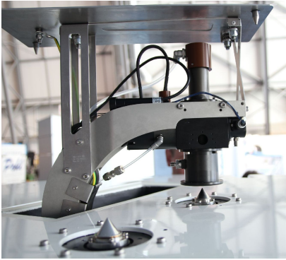
Abbildung 3.5: KaLIF im Bereitschaftszustand über der HO 2 -Einlassdüse. Für Kalibriermessungen wird KaLIF weiter abgesenkt, so dass der Fuß bündig mit der Messzellenoberseite abschließt. Während des Fluges wird KaLIF in die Parkposition in einen Kasten innerhalb der Topplattform gefahren, dessen rechteckige Öffnung hier zu erkennen ist.
