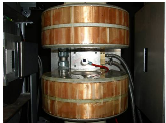
(b) Bild des Elektromagneten und der Probe am D17.
