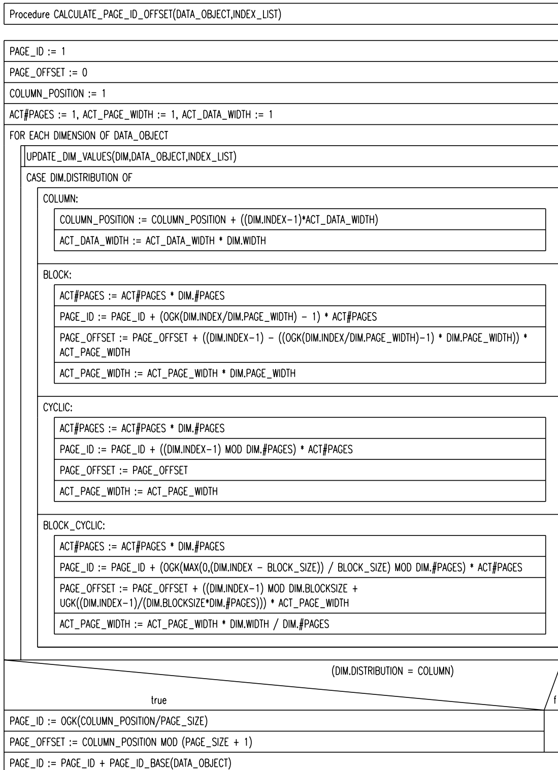
Abb. 20. Die Berechnung von PAGE_ID und PAGE_OFFSET für die beschriebenen Datenabbildungen
