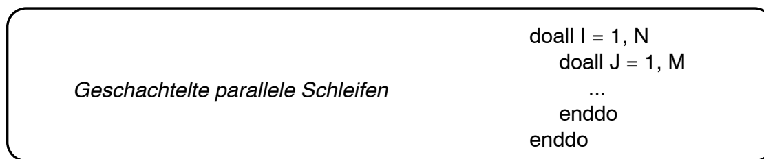
Abb. 25. Geschachtelte parallele Schleifen
