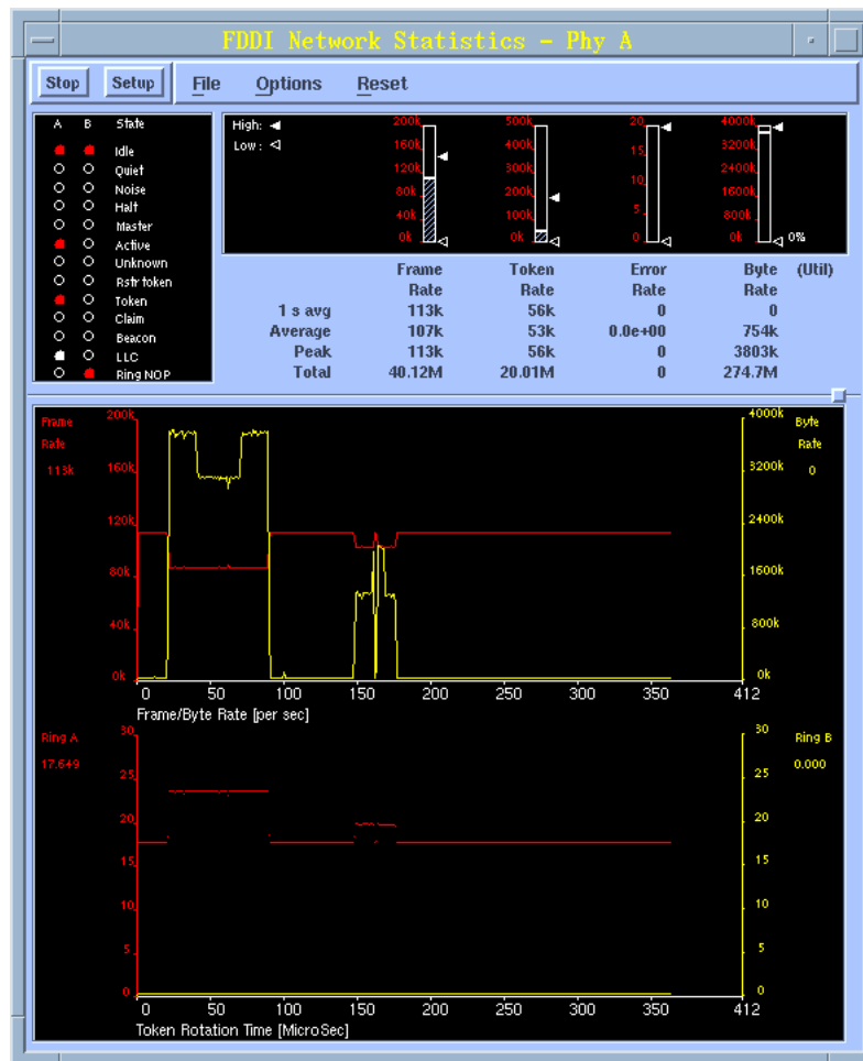
Abb. 4 Auslastung des FDDI-Testringes
