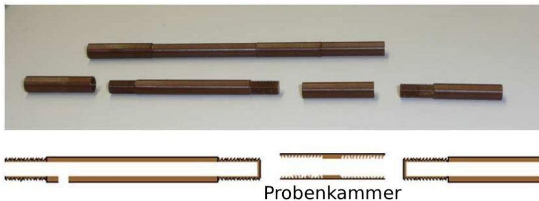
Abbildung 5.20: Probenhalter aus Vespel®/Polyimid, der für die Messungen von dispergierte Proben am PPMS benutzt wurde [11]. Die Probe wird in die Probenkammer gefüllt und von beiden Seiten luftdicht verschlossen. Der Probenhalter wird dann am linken Ende im PPMS befestigt.
