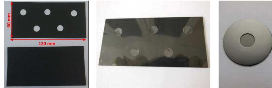
**Abb. 4-21: BSCF-Grünfolien vor der Lamination (links), nach der Lamination (mittig) und einzelne Probe nach der Sinterung (rechts).**
