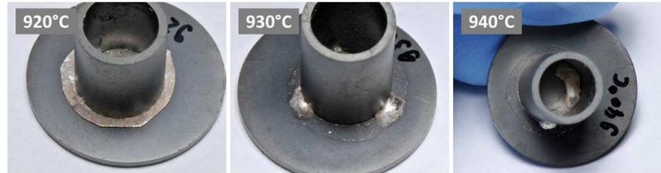
**Abb. 4-60: Anbindung mittels Ag-Folie bei  $920^\circ\text{C}$ ,  $930^\circ\text{C}$  und  $940^\circ\text{C}$ .**
