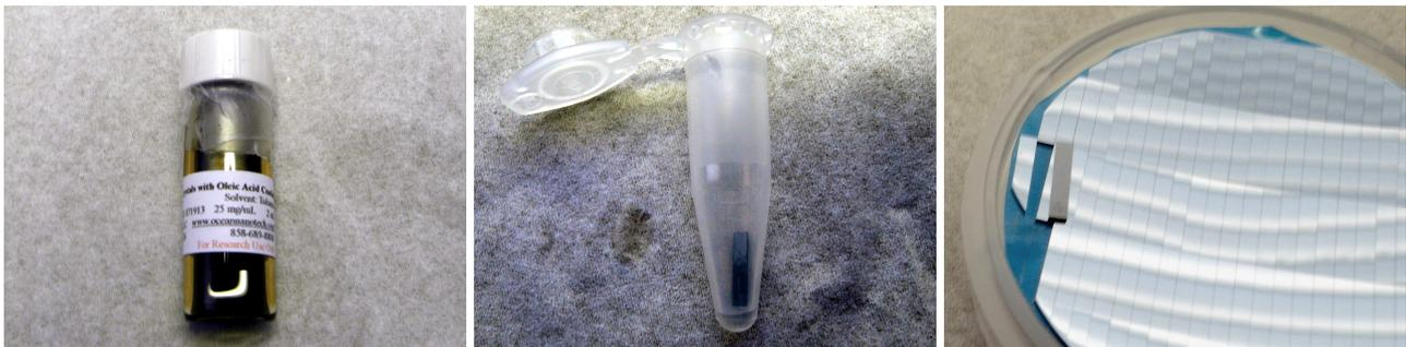
(a) 2 ml Nanopartikel-Dispersion (b) Probenröhrchen mit Substrat (c) zugeschnittene Substrate.
