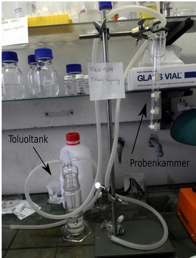
(a) Dampfkammer mit Glaszylinder (rechts oben, geöffnet) als Probenkammer und dem angeschlossenen Toluoltank (links unten). Der Stickstoff strömt von links ein, durchläuft den Tank und die Probenkammer und tritt durch ein Ventil (am Stativfuß) wieder aus.
