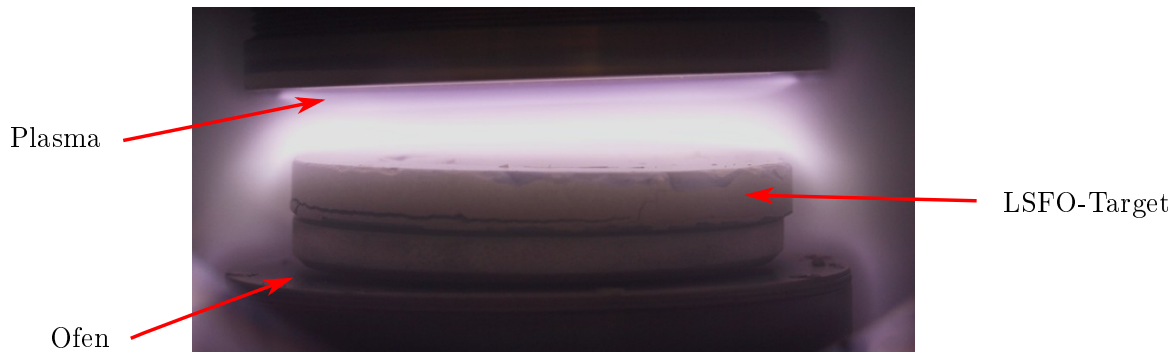
Abbildung 6.2.1.: Die Versilberung eines Targets für eine bessere thermische Kontaktierung beim späteren Sputtern. In der Sputteranlage wird das Target bei einer Temperatur von 750^{\circ}\text{C} unter einer Argonatmosphäre mit etwa 1\mu\text{m} Silber beschichtet. Aufgrund einer zu schnellen Heizrate hat sich bei diesem Target ein Riss an der Unterkante gebildet.
