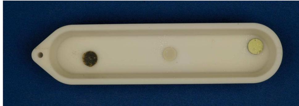
**Abbildung 13:** Aluminiumoxidschiffchen mit Protonenleiter für eine Auslagerung:  $\text{BaCe}_{0,2}\text{Zr}_{0,7}\text{Yb}_{0,08}\text{Ni}_{0,02}\text{O}_{3-\delta}$  (links),  $\text{La}_{5,5}\text{WO}_{12-\delta}$  (mitte),  $\text{BaCe}_{0,5}\text{Zr}_{0,4}\text{Y}_{0,1}\text{O}_{3-\delta}$  (rechts)
