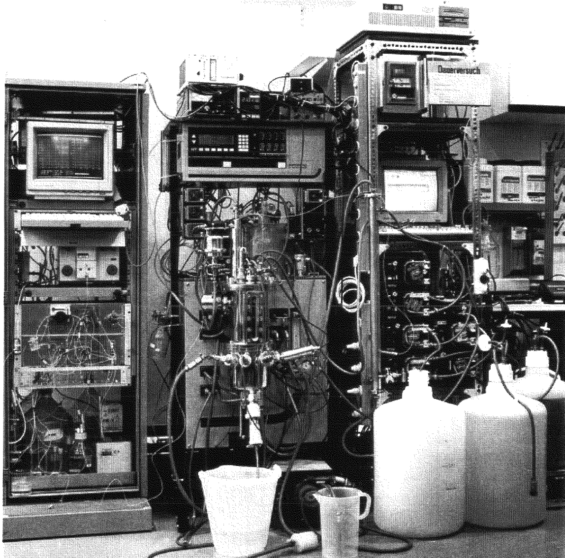
Abbildung A-2. Foto der Diafiltrationsanlage. Der Geräteschrank im linken Bildteil enthält die Fließinjektionsanalytik mit zugehörigem Steuerrechner. In der Mitte befindet sich der Bioreaktor mit der Steuereinheit, darüber die Analysegeräte für die Abgasanalytik. Unter dem Bioreaktor steht die Umlaufpumpe der Filtrationsstrecke. Auf den Regalen im rechten Bildteil sind Dosier- und Nachfüllpumpen, Dosierstrecke und –waagen sowie der Prozeßrechner untergebracht. Vor den Regalen stehen die Vorratsgefäße für das Verdünnungsmedium, die Glucoselösung und das Ablaufgefäß. Das SMP-Interface befindet sich auf einem Wandregal hinter dem Steuerrechner und ist im Bild nicht erkennbar.
