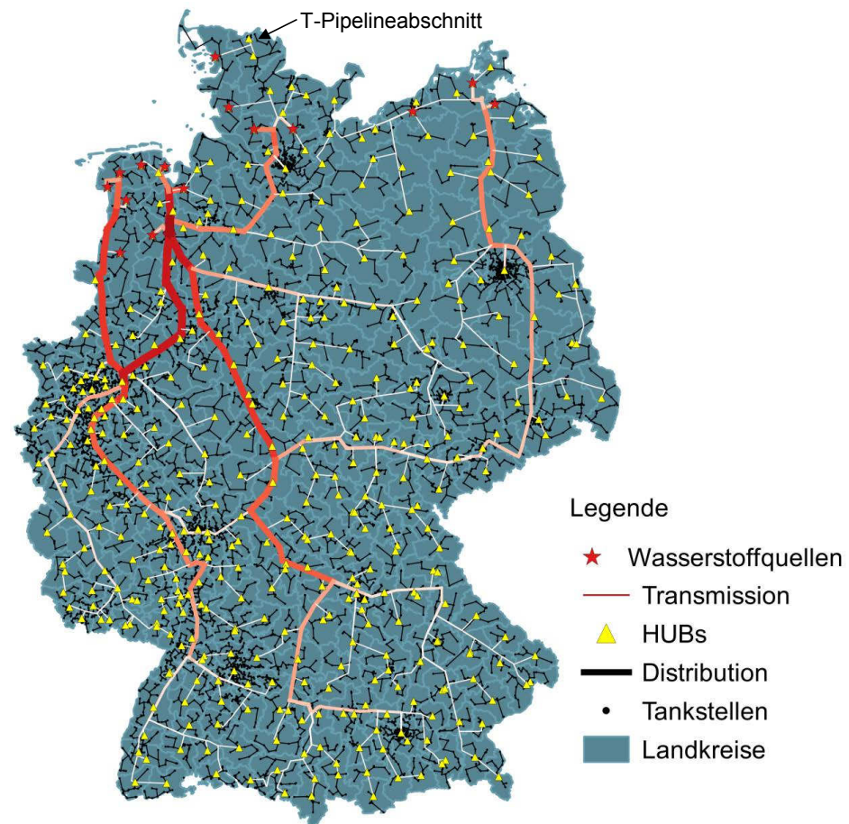
Abbildung 6.26: Wasserstoffpipeline zur Versorgung von \frac{3}{4} des deutschen Straßenverkehrs mit Wasserstoff aus einem regenerativen Energiekonzept
