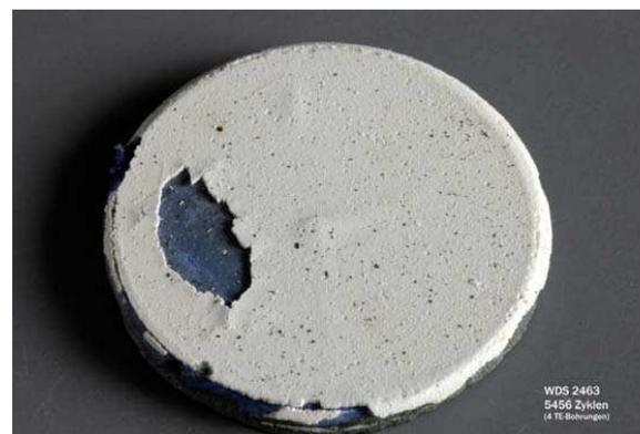
Abbildung 6-18: Photographie von WDS 2463 nach über 5000 Zyklen im Thermozykliertest mit 1250°C Oberflächentemperatur
