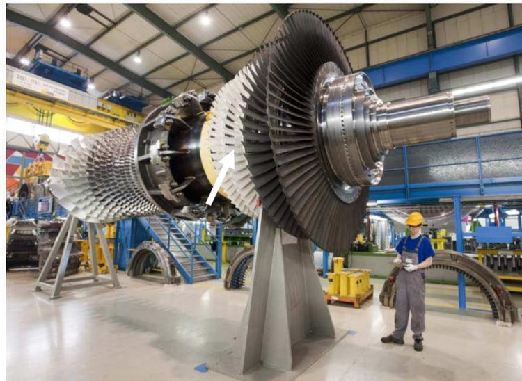
**Abbildung 2-2: Läufer einer modernen Gasturbine [9] (weiße Bereiche sind mit einer WDS beschichtet und mit Pfeil markiert)**
