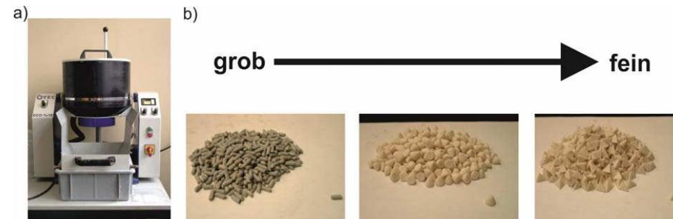
**Abbildung 4-4: Gleitschleifprozess zur Reduzierung der Bondcoatoberflächenrauigkeit: a) Gleitschleifmaschine Eco Pro (OTEC GmbH), b) Schleifsteine von "grob" nach "fein": ZSS 4/10, PX 10 und KX 10**
