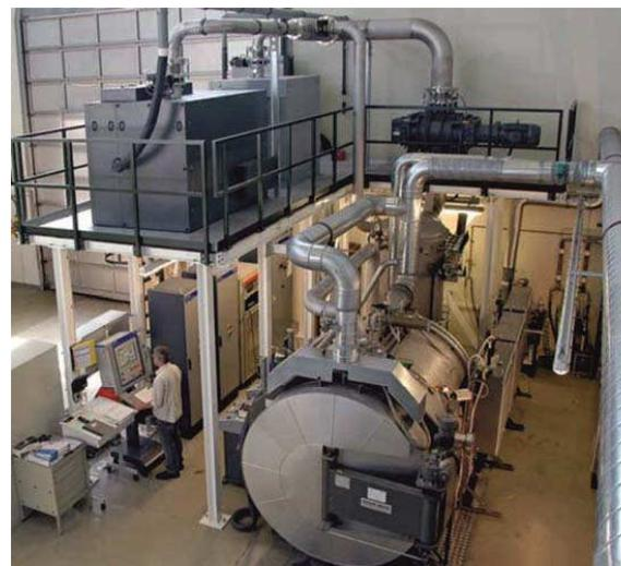
Abbildung 4-1: Photographie der eingesetzten Multicoat-VLPPS Anlage
