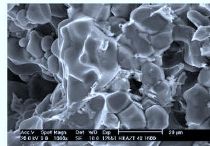
Abbildung 5: Mikrostrukturübersicht von feinkörnigem AZT Material, REM-Aufnahme, Vergrößerung  $1000\times$  [6].
