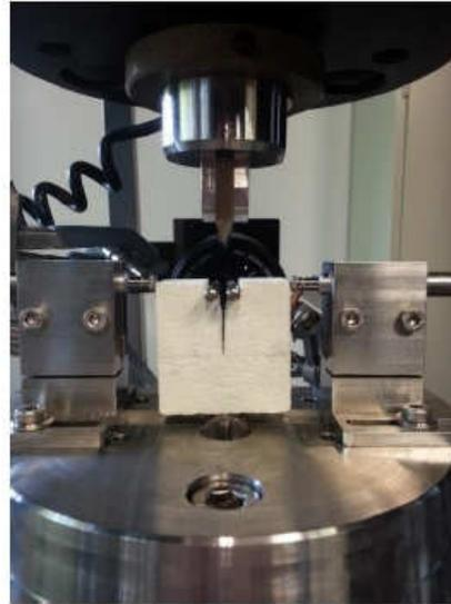
Abbildung 60: Versuchsaufbau des Keilspalttests mit Lasteinleitung 2.
