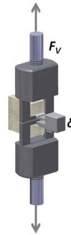
Abbildung 53: Schematische Darstellung des Kompaktzugversuches.  $F_V$  = Vertikalkraft,  $\delta$  = Kerböffnung
