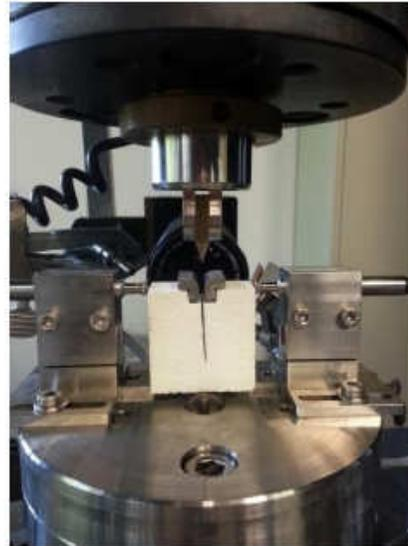
Abbildung 58: Versuchsaufbau des Keilspalttests mit Lasteinleitung 1.
