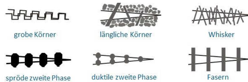
Abbildung 29: Rissverstärkungsmechanismen im Rissflankenbereich [69].
