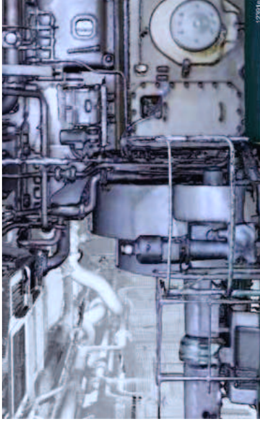
Abbildung 13: Integration einer Kinect-Aufnahme in einem Laserscan [12]
