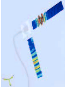
Abbildung 11: Charakterisierung von Aktoren mit Laservibrometrie (links: Scherwelle, rechts: Kompressions- und Longitudinalwelle)
