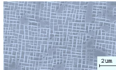
**Abbildung 2.4:** Mikrostruktur einer Ni-bas. Einkristall-Superlegierung mit  $\gamma/\gamma'$ -Gefüge. Bei den würfelförmigen Ausscheidungen handelt es sich um die  $\gamma'$ -Phase. Die Kanäle zwischen den Würfeln sind die  $\gamma$ -Matrix. Entnommen aus Referenz [10].
