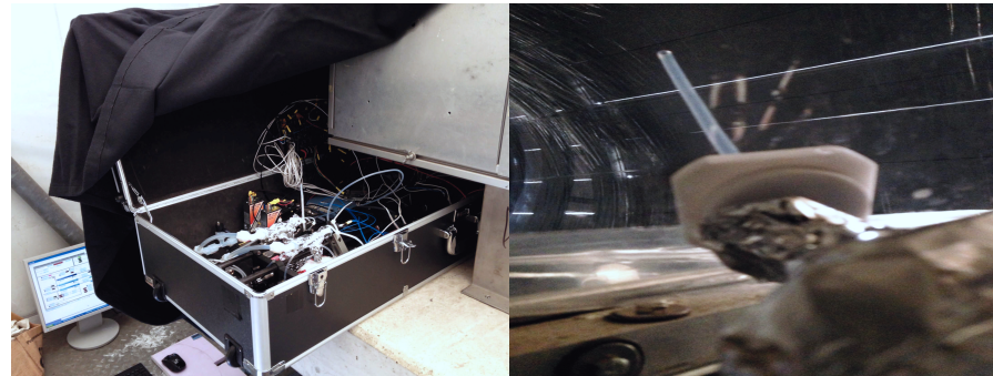
Abbildung 7.1: Die Installation des \text{NO}_3 -CRDS-Instruments an der SAPHIR-Simulationskammer. Links: Das \text{NO}_3 -CRDS-Instrument wurde in einer gepolsterten Munitionskiste am Südgiebel der SAPHIR-Kammer installiert. Der schwarze Vorhang schützt vor Lichteinfall. Der Deckel der Kiste musste aus Platz- und Temperaturgründen (Stauhitze) geöffnet bleiben. Rechts: Die Einlassleitung des \text{NO}_3 -CRDS-Instruments wurde direkt durch die Kammerfolie gelegt und circa 30 cm weit ins Innere der Kammer geführt.
