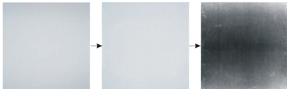
Fotografierte Graupappe mit Beleuchtungsinhomogenitäten
