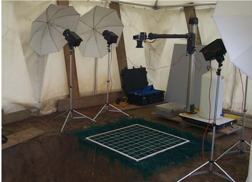
Abbildung 12: Instrumentierung (Kamera mit Stativ, vier Repro-Blitzleuchten) zur fotografischen Erfassung der horizontalen Bodenoberflächen.
