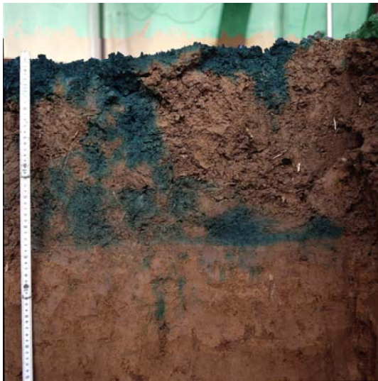
Abbildung 65: Pflughorizont auf Plot L p,0 unmittelbar nach der Beregnung mit der Pflugschleife im Übergangsbereich zum ungestörten Unterboden (Bt-Horizont).
