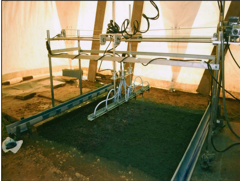
Abbildung 10: Beregnung von Plot L_{g,s} mit dem automatischen Sprinkler.
