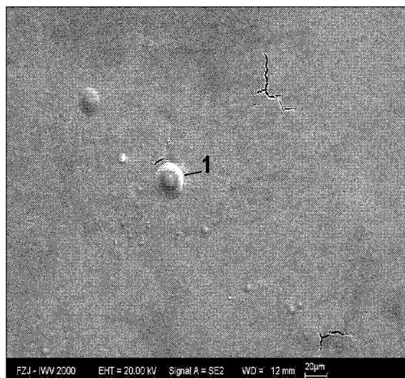
*Abb. 120: REM-Aufnahme der MCrAlY-Legierung FTR als freistehende Schicht nach Elektronenstrahl-Behandlung*
