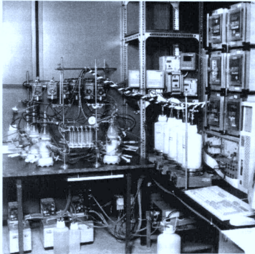
Abb. 4-4 : Photographie der Parallelermentationsanlage, wie sie z.B. zum Cosubstratscreening in kontinuierlicher Fermentation eingesetzt wurde.
