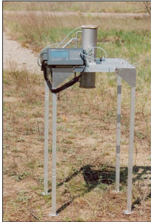
Abbildung 1-7: Bodenmessung (Ortsdosis) mit dem Messsystem MAB500
