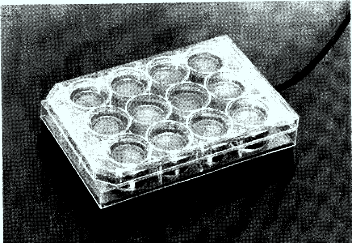
Abbildung 5.10: Fotografie des Miniatur-Schlaufenreaktors
