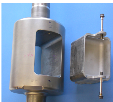
Gehäuse mit Chopper
