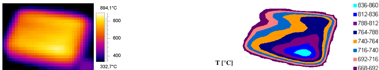
Abb. H.28: IR-Bild und Oberflächentemperaturprofil bei einer Elektronenstrahlbelastung von 11.3 \text{ MW/m}^2
