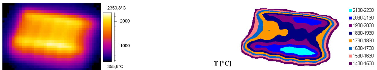
Abb. H.10: IR-Bild und Oberflächentemperaturprofil bei einer Elektronenstrahlbelastung von 18.1 \text{ MW/m}^2
