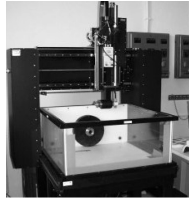
Abb. 2.16: Ultraschall-Messanlage der Fa. Panametrics: Messbecken, 4-Achsen Verschiebesystem und Positioniervorrichtung
