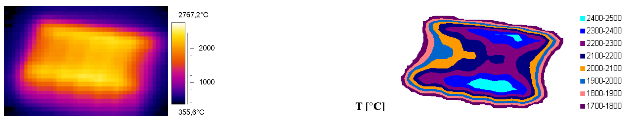
Abb. H.14: IR-Bild und Oberflächentemperaturprofil bei einer Elektronenstrahlbelastung von 21 \text{ MW/m}^2
