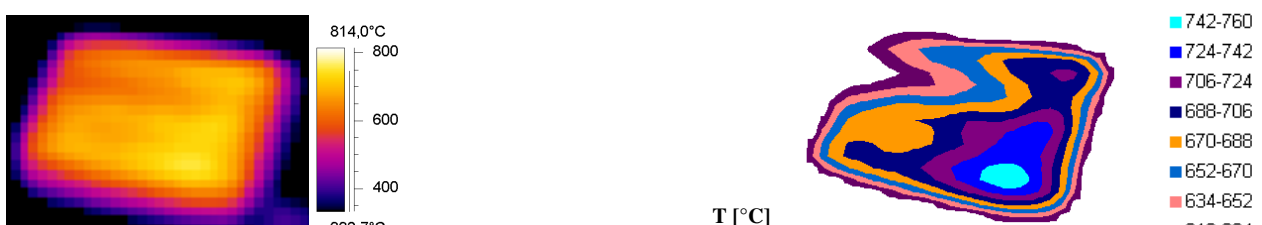
Abb. H.27: IR-Bild und Oberflächentemperaturprofil bei einer Elektronenstrahlbelastung von 10.2 \text{ MW/m}^2
