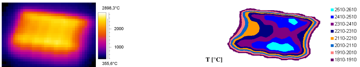
Abb. H.16: IR-Bild und Oberflächentemperaturprofil bei einer Elektronenstrahlbelastung von 22.8 \text{ MW/m}^2
