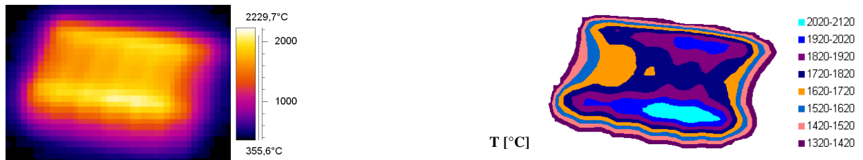
Abb. H.9: IR-Bild und Oberflächentemperaturprofil bei einer Elektronenstrahlbelastung von 17.1 \text{ MW/m}^2
