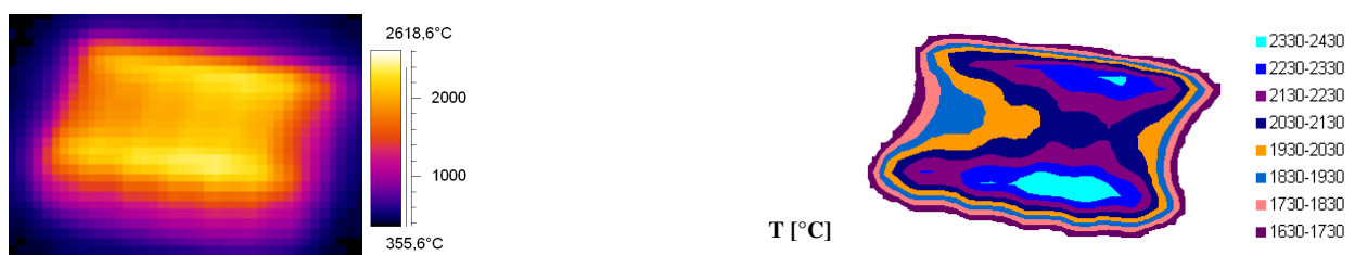
Abb. H.13: IR-Bild und Oberflächentemperaturprofil bei einer Elektronenstrahlbelastung von 20 \text{ MW/m}^2
