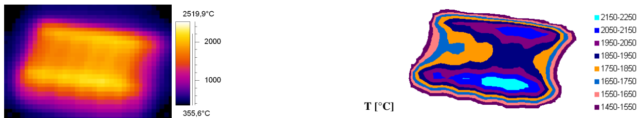
Abb. H.11: IR-Bild und Oberflächentemperaturprofil bei einer Elektronenstrahlbelastung von 18.1 \text{ MW/m}^2
