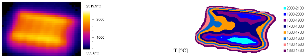
Abb. H.12: IR-Bild und Oberflächentemperaturprofil bei einer Elektronenstrahlbelastung von 19.3 \text{ MW/m}^2
