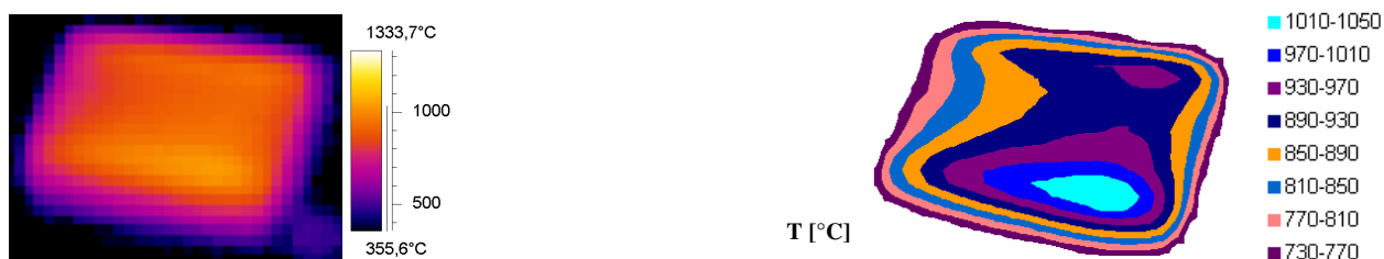
Abb. H.31: IR-Bild und Oberflächentemperaturprofil bei einer Elektronenstrahlbelastung von 14.7 \text{ MW/m}^2
