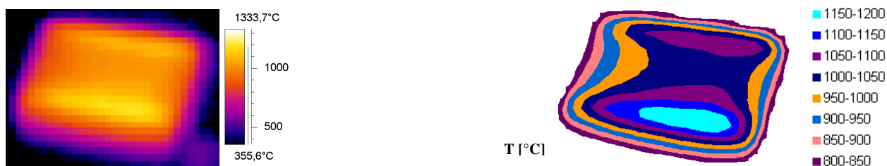
Abb. H.33: IR-Bild und Oberflächentemperaturprofil bei einer Elektronenstrahlbelastung von 15.9 \text{ MW/m}^2
