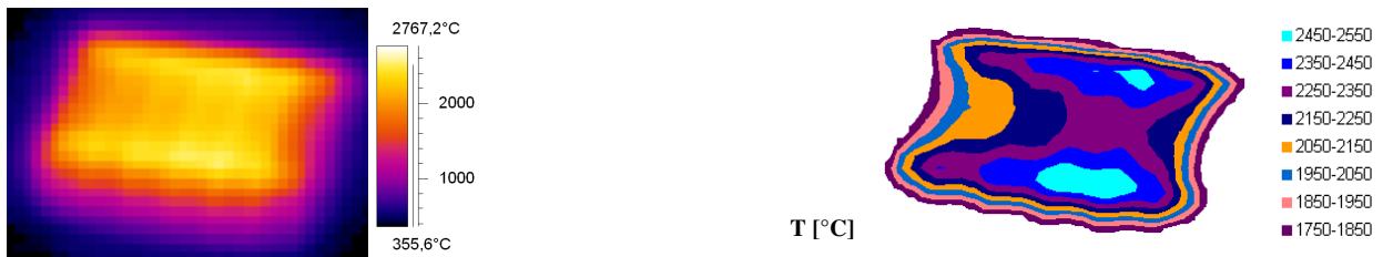
Abb. H.15: IR-Bild und Oberflächentemperaturprofil bei einer Elektronenstrahlbelastung von 21.9 \text{ MW/m}^2
