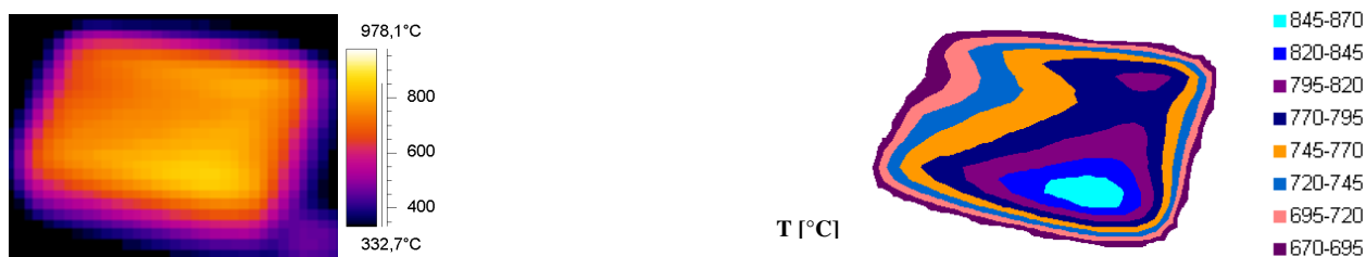
Abb. H.29: IR-Bild und Oberflächentemperaturprofil bei einer Elektronenstrahlbelastung von 12.5 \text{ MW/m}^2
