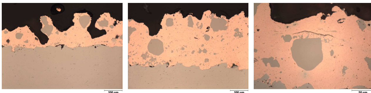
Abb. D.2: LM-Bilder – W/Cu-Schicht, hergestellt aus Cu-beschichtetem W-Pulver mittels W-Parametern
