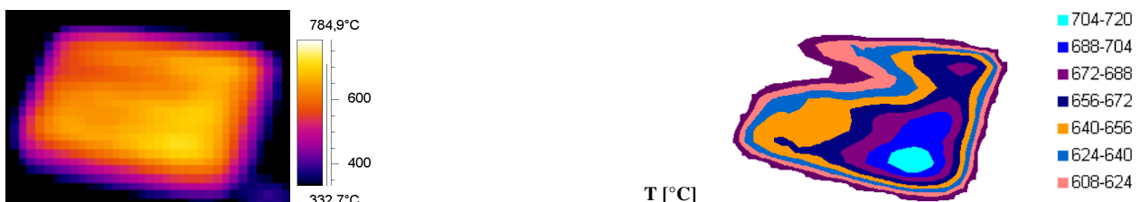
Abb. H.26: IR-Bild und Oberflächentemperaturprofil bei einer Elektronenstrahlbelastung von 9.1 \text{ MW/m}^2
