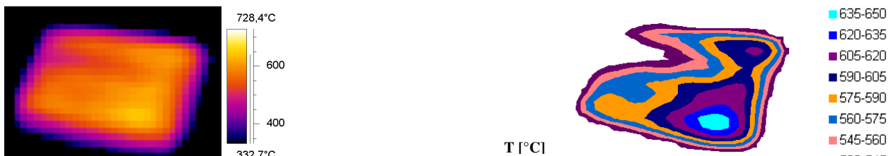
Abb. H.25: IR-Bild und Oberflächentemperaturprofil bei einer Elektronenstrahlbelastung von 7.9 \text{ MW/m}^2
