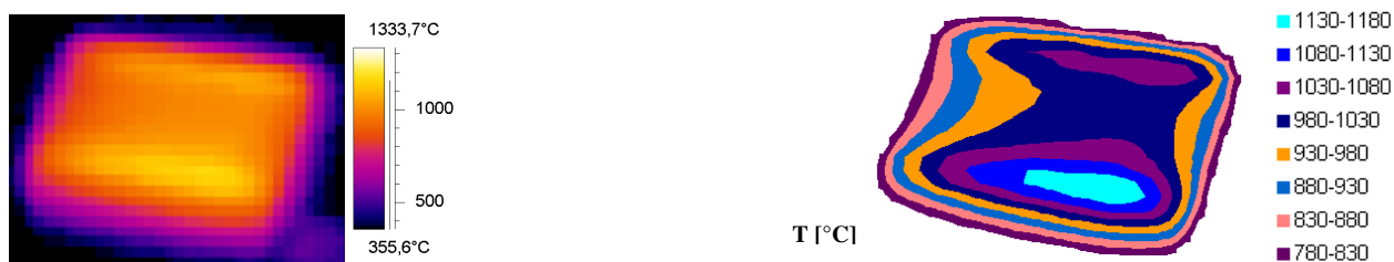
Abb. H.32: IR-Bild und Oberflächentemperaturprofil bei einer Elektronenstrahlbelastung von 14.7 \text{ MW/m}^2
