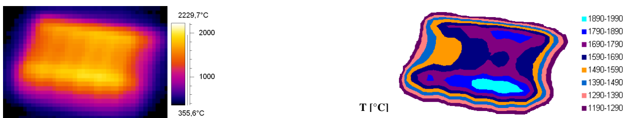
Abb. H.8: IR-Bild und Oberflächentemperaturprofil bei einer Elektronenstrahlbelastung von 16,2 \text{ MW/m}^2
