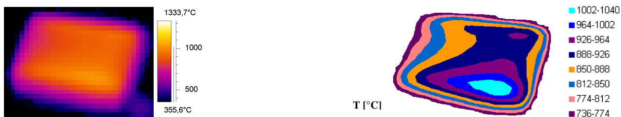
Abb. H.30: IR-Bild und Oberflächentemperaturprofil bei einer Elektronenstrahlbelastung von 13.6 \text{ MW/m}^2
