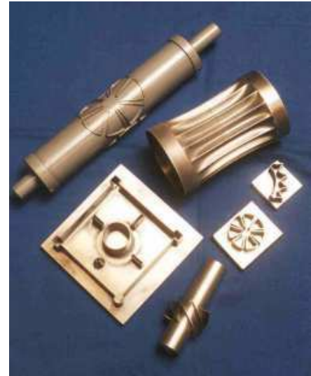
Abb. 2.7: gefertigte Bauteile (3D-Formen, Schneidwalzen, Vorformen) am NRC/IMTI unter dem Titel „Free Form Laser Consolidation“, keine Oberflächenbehandlung
