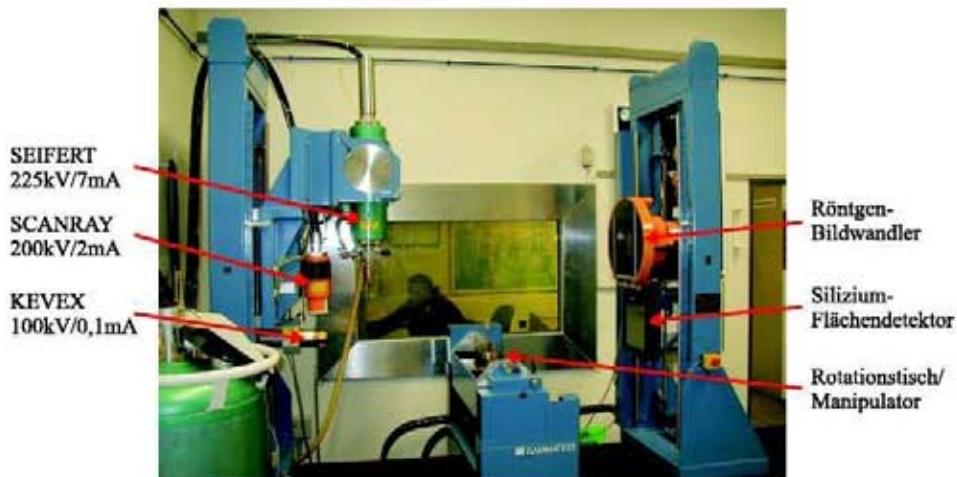
Abbildung 3.1: Aufbau einer Mikrofokus-Röntgenanlage. Das System besteht aus drei Röntgenröhren unterschiedlicher Leistungen und Fokusgrößen, zwei Detektoren und einem Manipulator zur Positionierung der Untersuchungsobjekte. Für die MikroCT-Aufnahmen wurden die Röhre kleinster Fokusgröße und der Silizium-Flächendetektor eingesetzt.
