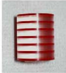
Abbildung 3.7: Die Zusammensetzung des Defrise-Phantom. Das Bild des physikalischen Phantoms zeigt ein zylinderförmiges Gebilde, das sich aus 1 mm dickem roten PVC und 3 mm dickem Plexiglas zusammensetzt. Der Durchmesser beträgt 20mm.
