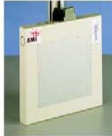
Abbildung 3.3: Verwendeter Detektor. Der Silizium-Flächendetektor der Firma AMI besitzt eine verhältnismäßig große Aufnahmefläche und ist für niederenergetische Aufnahmen geeignet.
