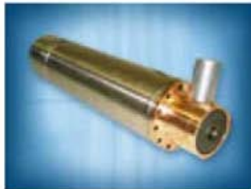
Abbildung 3.2: Mikrofokusröhre. Diese Röntgenquelle ist eine Transmissionsquelle mit einer Wolframanode und hat eine Fokusgröße von 10\ \mu\text{m} bei einer Maximalspannung von 100 kV und einem Maximalstrom von 0,1 mA.
