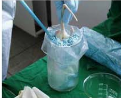
Abbildung 3.22: Präparation der Ratte. Eine gefrorene Ratte wurde in Bauschaum eingegossen, um eine höhere Stabilität und bessere Positionierfähigkeit bei der CT-Messung zu erreichen.
