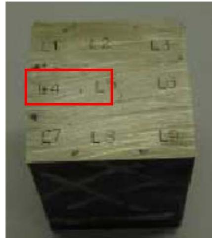
**Abbildung 4.6:** Querschnitt des Schmiedestückes
