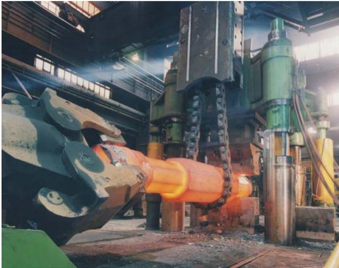
**Abbildung 1.4:** Turbinenwelle beim Schmieden
