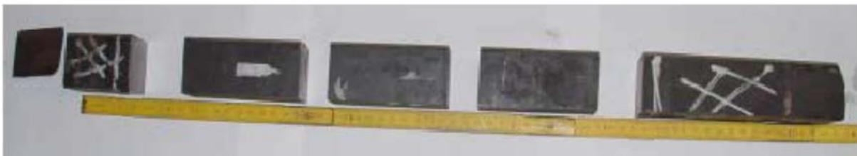
**Abbildung 4.5:** Makroaufnahme vom Schmiedestück der Legierung DT 706 (Charge 861)
