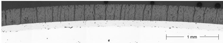
Abbildung 3.58: Panoramabild nach über 2% Dehnung bei 950°C (ohne Auslagerung).
