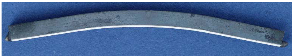
Abbildung 3.55: Bild einer bei 950°C verformten (1,5%) Biegeprobe (APS) ohne Schädigung
