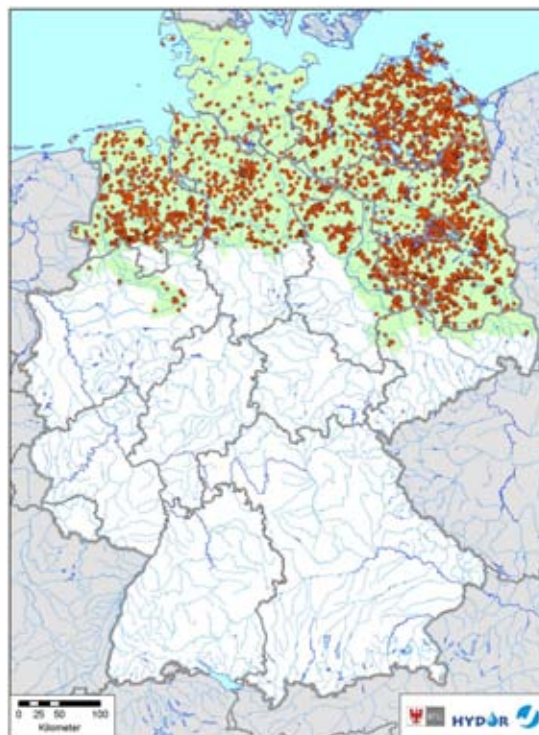
Karte 5: Verbreitung der hydrogeologischen Einheit „Sande und Kiese des Norddeutschen Flachlandes mit Entnahmetiefen zwischen 25 und 50 m“ und ausgewertete Grundwassermessstellen.
