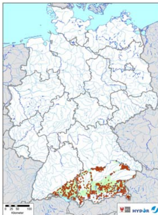
Karte 8: Verbreitung der hydrogeologischen Einheit „Schotter- und Moränenablagerungen des Alpenvorlandes“ und ausgewertete Grundwassermessstellen
