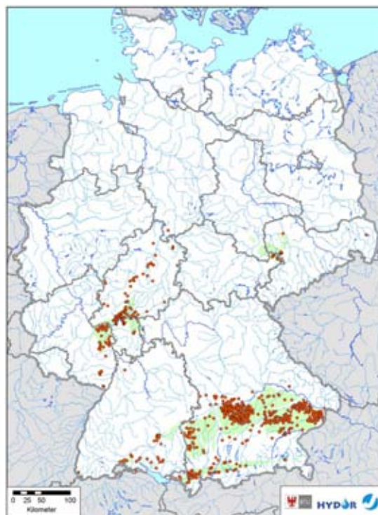
Karte 9: Verbreitung der hydrogeologischen Einheit „tertiäre Sedimente“ und ausgewertete Grundwassermessstellen.
