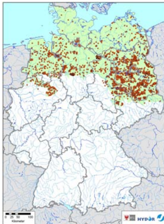
Karte 3: Verbreitung der hydrogeologischen Einheit „Sande und Kiese des Norddeutschen Flachlandes mit Entnahmetiefen unter 10 m“ und ausgewertete Grundwassermessstellen.
