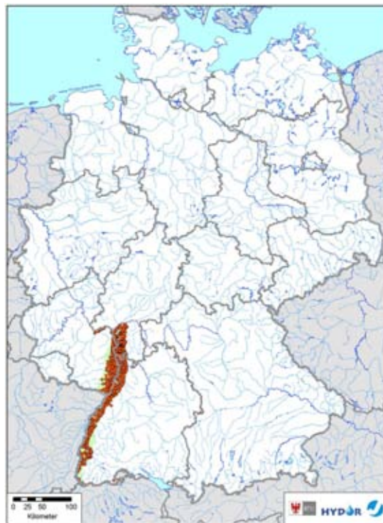
Karte 7: Verbreitung der hydrogeologischen Einheit „Schotter und Kiese des Oberrheins“ und ausgewertete Grundwassermessstellen.
