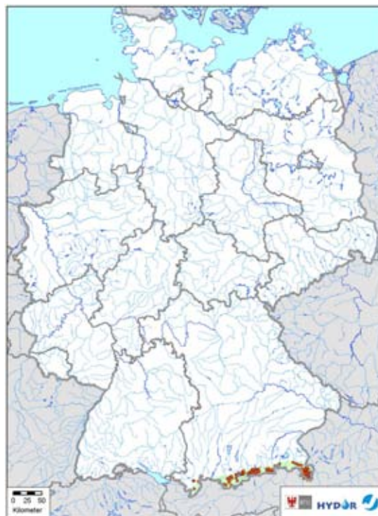
Karte 12: Verbreitung der hydrogeologischen Einheit „Kalksteine des alpinen Raumes“ und ausgewertete Grundwassermessstellen.
