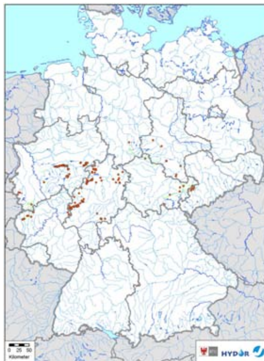
Karte 13: Verbreitung der hydrogeologischen Einheit „paläozoische Kalksteine“ und ausgewertete Grundwassermessstellen.
