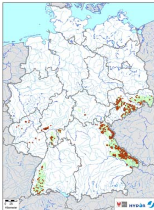
Karte 19: Verbreitung der hydrogeologischen Einheit „saure Magmatite und Metamorphite“ und ausgewertete Grundwassermessstellen.
