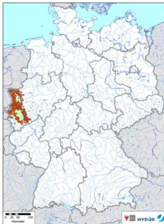
Karte 6: Verbreitung der hydrogeologischen Einheit „Schotter und Kiese des Niederrheins“ und ausgewertete Grundwassermessstellen.
