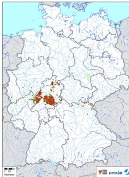
Karte 18: Verbreitung der hydrogeologischen Einheit „Vulkanite“ und ausgewertete Grundwassermessstellen.
