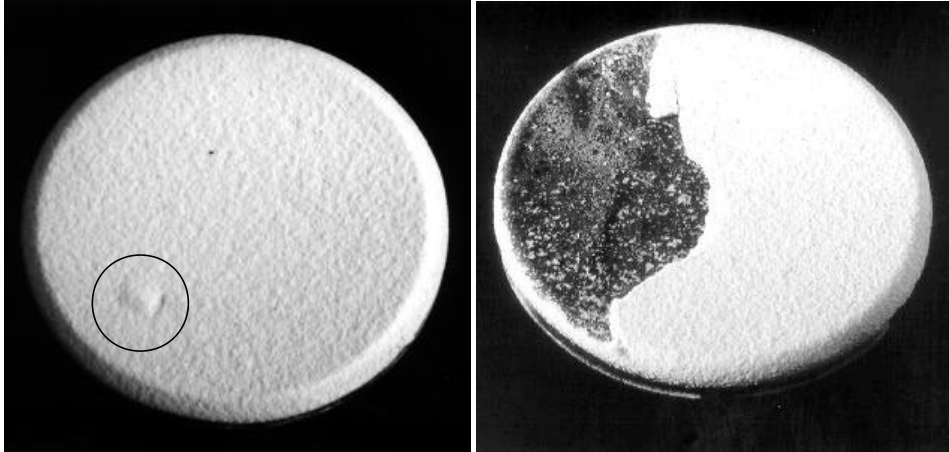
Abbildung 84 Fotos von zyklisierten Doppellagen-Systemen mit Toplagen aus \text{La}_2\text{Zr}_2\text{O}_7 , links: 1000 Zyklen mit T_{\text{Oberfl.}} 1357^\circ\text{C} , T_{\text{Haftvermittlerschicht}} 1027^\circ\text{C} (WDS 41), rechts: 1609 Zyklen mit T_{\text{Oberfl.}} 1341^\circ\text{C} , T_{\text{Haftvermittlerschicht}} 1052^\circ\text{C} (WDS 68).
