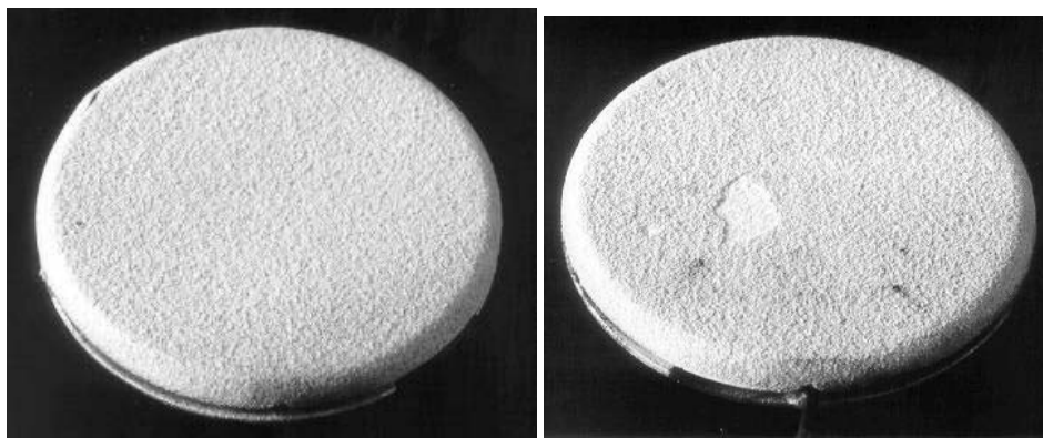
Abbildung 75 Fotos von zyklerten \text{Nd}_2\text{Zr}_2\text{O}_7 /YSZ-Doppellagen – Systemen, links: 2488 Zyklen mit T_{\text{Oberfl.}} 1219 °C, rechts: 1748 Zyklen mit T_{\text{Oberfl.}} 1325 °C.
