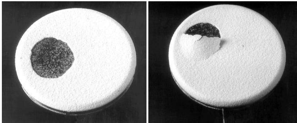
Abbildung 77 Fotos von zyklerten YSZ-Schichten, links: 5384 Zyklen mit T_{\text{Oberfl.}} 1244\text{ °C} (WDS 21), T_{\text{Haftvermittlerschicht}} 994\text{ °C} , rechts: 1727 Zyklen mit T_{\text{Oberfl.}} 1242\text{ °C} , T_{\text{Haftvermittlerschicht}} 1026\text{ °C} (WDS 63).
