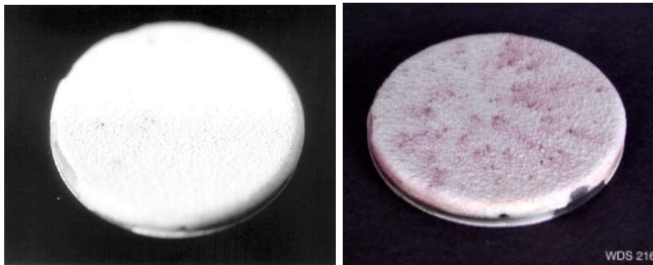
Abbildung 82 Fotos von zyklisierten SrZrO 3 -Schichten, links: 100 Zyklen mit T_{\text{Oberfl.}} 1248\text{ }^{\circ}\text{C} , T_{\text{Haftvermittlerschicht}} 1047\text{ }^{\circ}\text{C} , rechts: 70 Zyklen mit T_{\text{Oberfl.}} 1354\text{ }^{\circ}\text{C} , T_{\text{Haftvermittlerschicht}} 1093\text{ }^{\circ}\text{C} .
