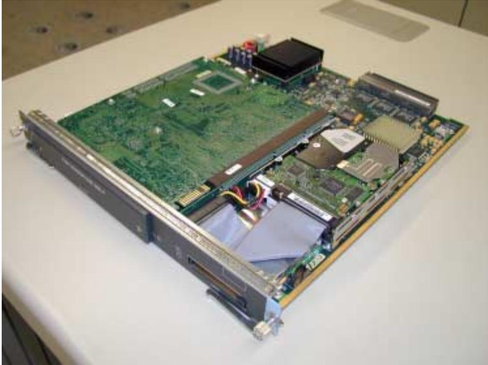
Das Network Analysis Modul für den Catalyst 6000 Switch benötigt einen Slot im Switch und ist auf der Basis einer 533 MHz Pentium III CPU mit 256 MB RAM und Festplatte sowie eines UNIX- Betriebssystems, das für den Switch-Administrator nicht sichtbar ist, aufgebaut. Für die RMON-Tabellen stehen insgesamt 256 MB zur Verfügung; bis zu 70 MB davon für den Capture Buffer.
