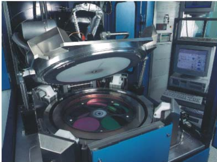
Abbildung 3.6: Der Aixtron MOCVD Reaktor 2600G3, der vom PC aus bedient wird. Auf dem Suszeptor befinden sich fünf 6“ große Substrate.
