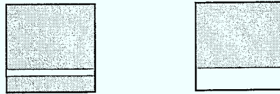
Abb. 3.2: Zur Vermeidung von Kurzschlüssen beim Aufdampfen des metallischen Rückkontaktes ist ein Teil des ITOs abgeätzt worden. Für die UHV-Anlage (links) und die HV-Anlage (rechts) sind die Substrate unterschiedlich vorbereitet worden (aus [82]).
