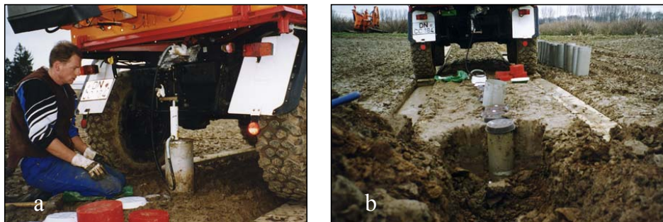
Abbildung 16 a: Eintreiben der Bodensäulen mittels einer Hydraulik-Presse b: die Bodensäulen wurden auf einer Länge von 13,4 m in einer Reihe entnommen.
