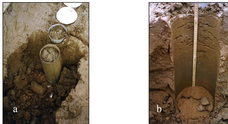
Abbildung 17 a: Freilegen der Bodensäulen; b: Ansicht des Bodenprofils nach Säulenentnahme.
