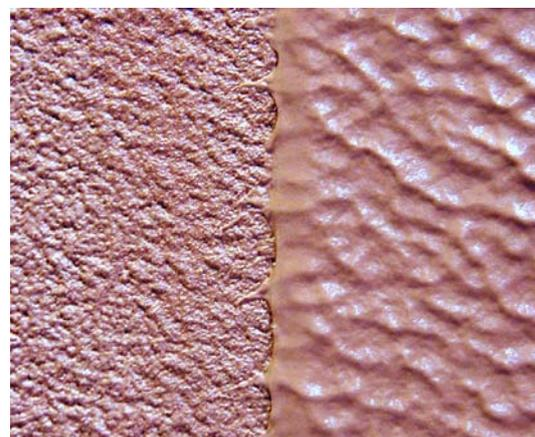
**Abb. 36 Beschichtung mit Silikon RT 622    Abb. 37 Unterschiede in Oberflächenglätte (Silikon RT 622)**
