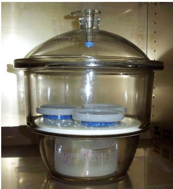
Abb. 12 Exsikkator mit Salzlösung und Prüfschalen
