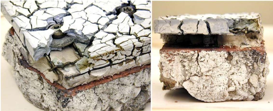
**Abb. 72 Silikonstruktur nach der thermischen Behandlung bei 650°C**
