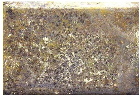
**Abb. 48** Getauchte Stahlproben nach der Entfernung der Silikonbeschichtung RT 772
