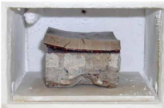
**Abb. 62** Probe im Muffelofen bei 400°C
