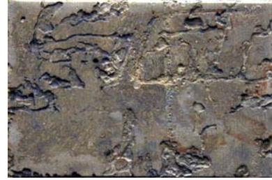
**Abb. 44 Unbeschichtete Stahlproben (S1) nach der Entfernung der Korrosionsprodukte (1,65 fache Vergrößerung)**
