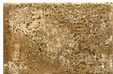
**Abb. 45 Stahlproben nach der Entfernung der Epoxydlack-Beschichtung (EP2) (1,65 fache Vergrößerung)**
