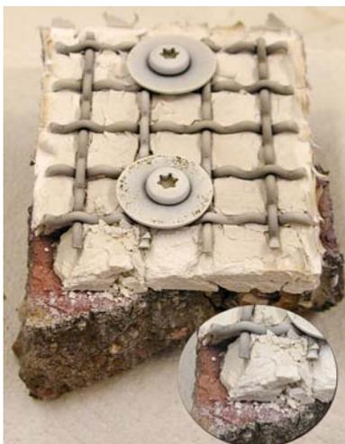
**Abb. 66** Probe nach der thermischen Behandlung bei 650°C
