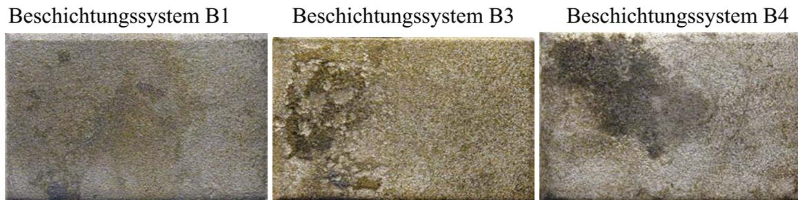
**Abb. 50 Stahlproben nach der Entfernung der Beschichtungen und Korrosionsprodukten (1,65 fache Vergrößerung)**
