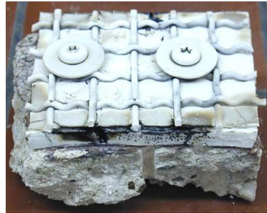
**Abb. 69** Silikonstruktur nach der Behandlung bei 900 °C
