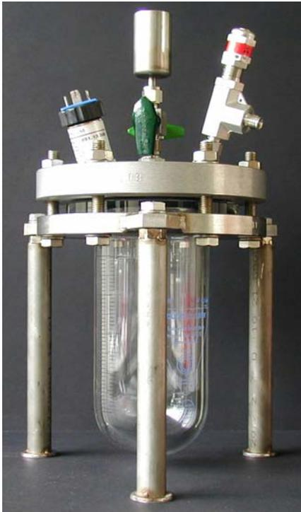
**Abb. 14 Wasserstoffbehälter mit Polysiloxanstopfen**
