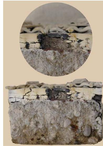
**Abb. 65** Probe nach der Behandlung bei 500 °C
