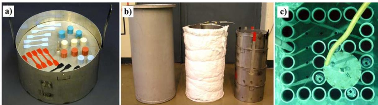
**Abb. 22 Bestrahlungsversuche: a) Behälter mit Proben, b) Bestrahlungscontainer, c) Bestrahlungscontainer zwischen vier Brennelementen**
