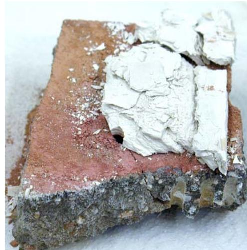
**Abb. 67** Silikonstruktur nach der Behandlung bei 650 °C
