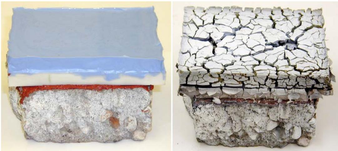
**Abb. 71** Probe vor und nach der thermischen Behandlung bei 650°C
