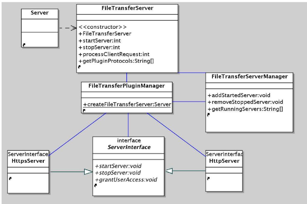
Abbildung 3.6: UML - Diagramm zur Festlegung der Schnittstellen (Server)
