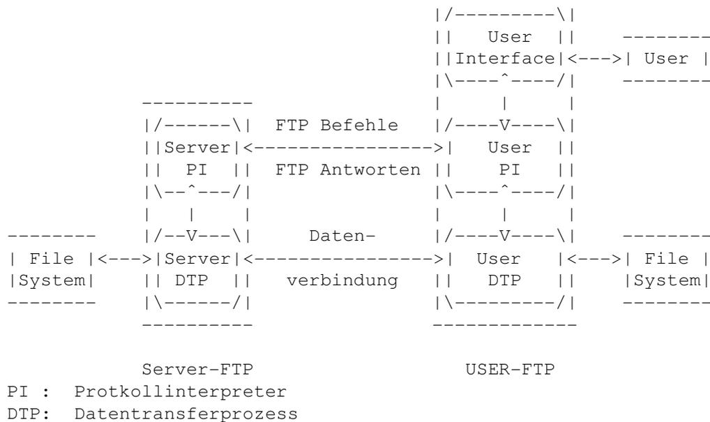
Abbildung 2.3: FTP Verbindungsdiagramm [6]
