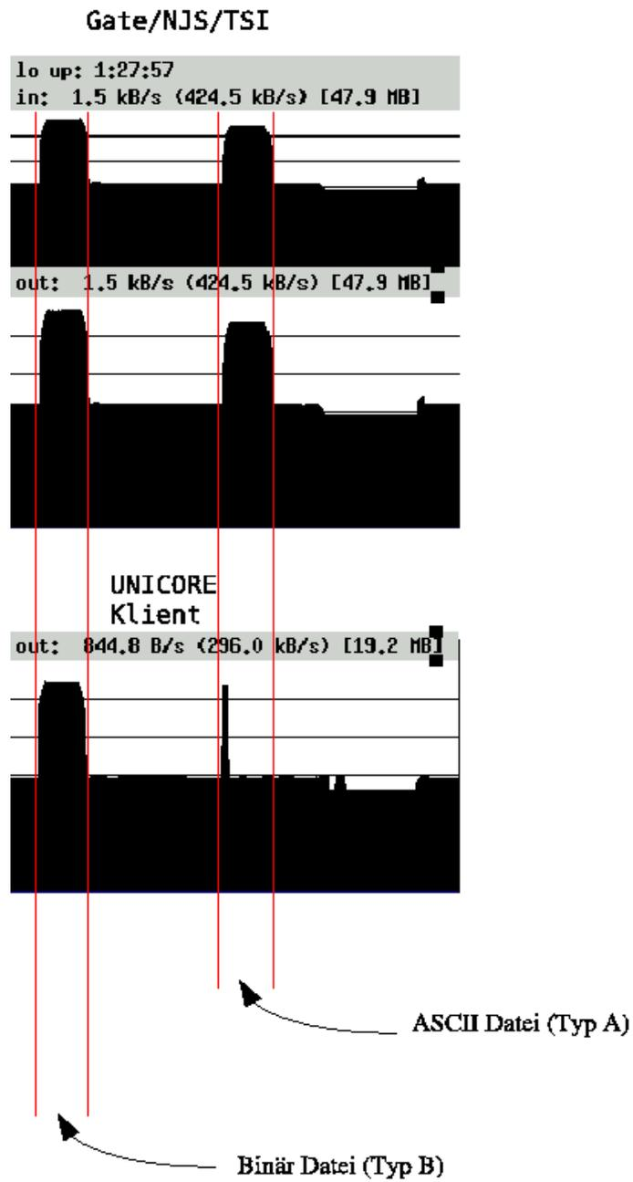
Abbildung 6.2: Netzauslastung von UPL (Screenshot von xnetload)
