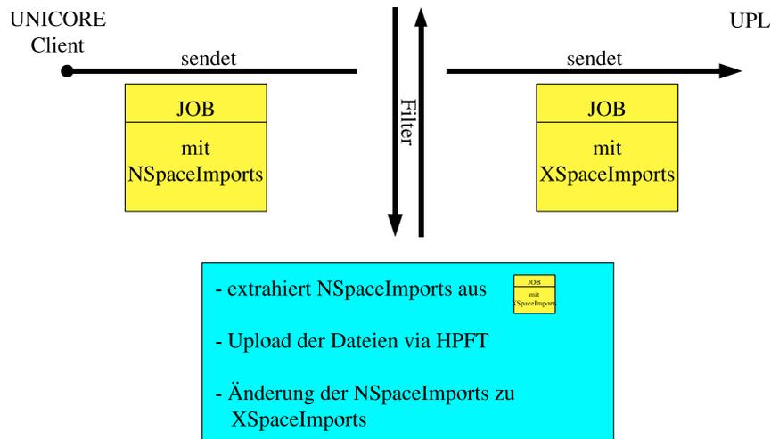
Abbildung 4.3: HPFT Plugin Send-Filter
