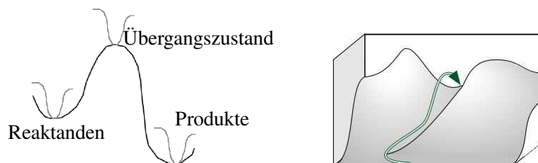
Abbildung 1: Schematische Darstellung eines Reaktionspfades in Abhängigkeit von zwei Freiheitsgraden (rechtes Bild) und dessen Projektion auf die Reaktionskoordinate (linkes Bild).
