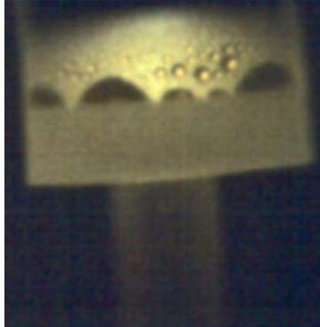
Abbildung 1.2: Metallhalogenidentladungslampe gefüllt mit einer Natriumjodid-Thalliumjodid-Calciumjodid-Cerjodid -Aluminiumjodid-Mischung
