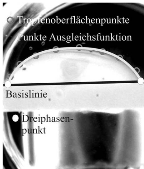
*Abbildung 4.2:* Schematische Darstellung der Kontaktwinkelbestimmung
