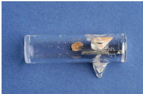
*Abbildung 4.4:* Bild einer Randwinkelampulle mit reinem Ca<sub>2</sub> und Kohlenstoffplatte
