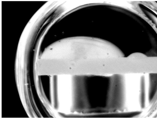
Abbildung 3.4: Photo eines Calciumjodidtropfens auf einer Platte umgeben von einer Gasphase aus Calciumjodid und Argon
