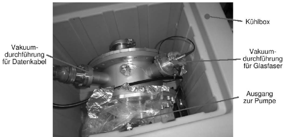
Abbildung A.12: Vakuumbehälter für OJSTER, Aufbau zum Dichtigkeitstest des Behälters
