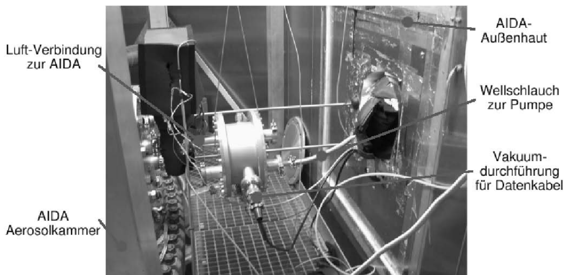
Abbildung A.13: Position des Vakuumbehälters an der AIDA: Zwischen Außenhaut und Aerosolkammer
