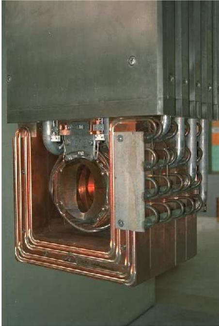
Abb. 7.1.1-3: Modul der Protonenstrahlführung
