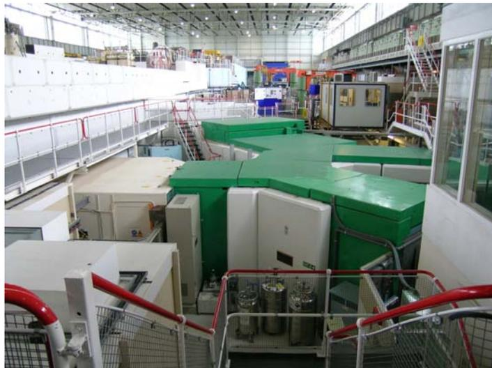
Abb. 4.2.3-1: Metallcontainer gefüllt mit Paraffin (grüne Platten) als Abschirmung bei Spallationsquelle ISIS Rutherford Laboratory (RAL, England)
