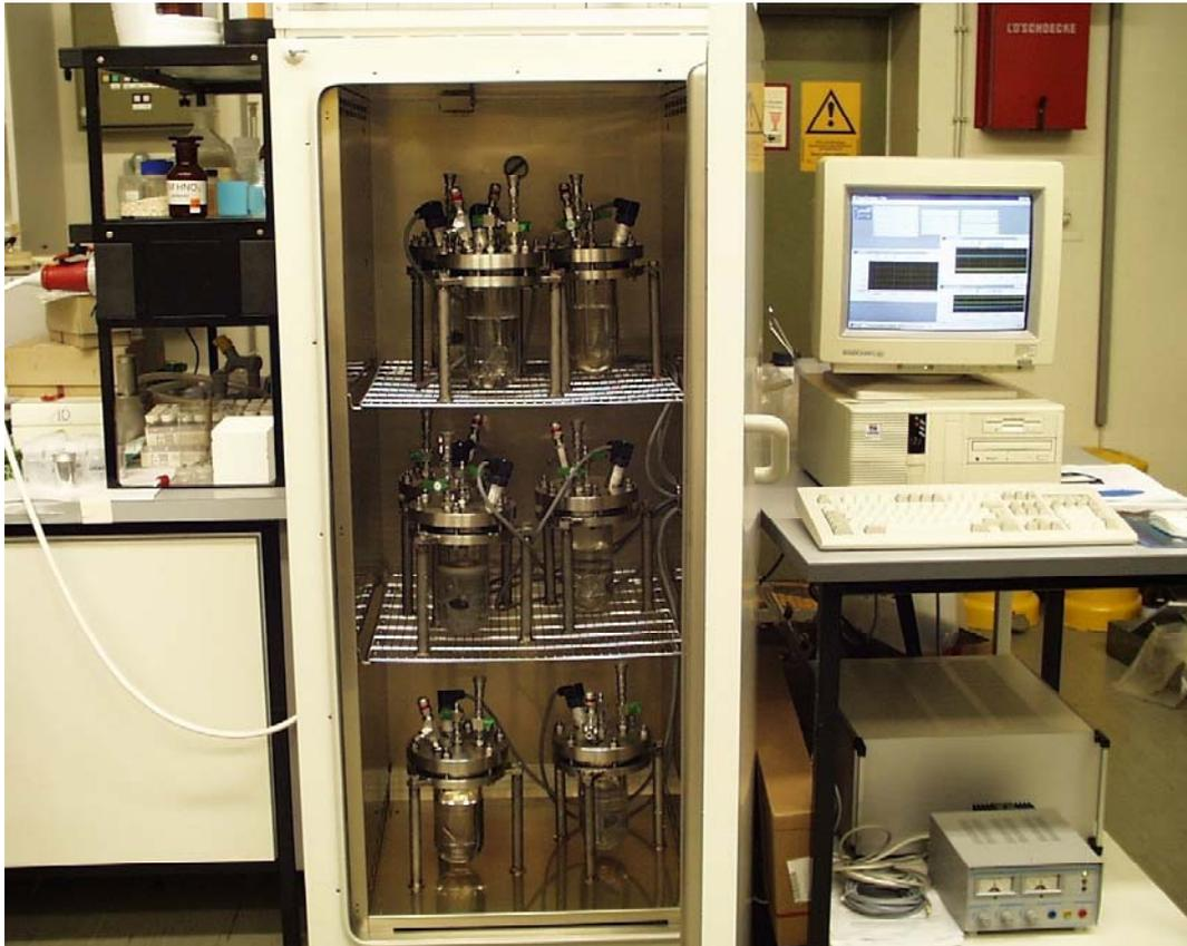
Abbildung 3 Versuchseinrichtung für die Auslaugversuche mit unbestrahlten FR-Brennelementen
