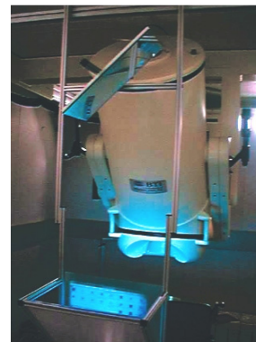
Abbildung 33: Projektor mit Verschluss und optisches Umlenkensystem zur visuellen Stimulation
