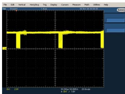
Abbildung 89: Lichtwellenleiter Interface Signale und Zeitdiagramme
