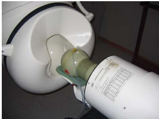
Abbildung 58: Phantom mit 5 Dipolen im MEG Messkopf zur Stromdichterekonstruktion
