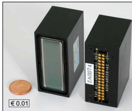
Abbildung 4.14: Vor- und Rückseite des H7260-20 Multianoden Photomultipliers mit 32 Kanälen.
