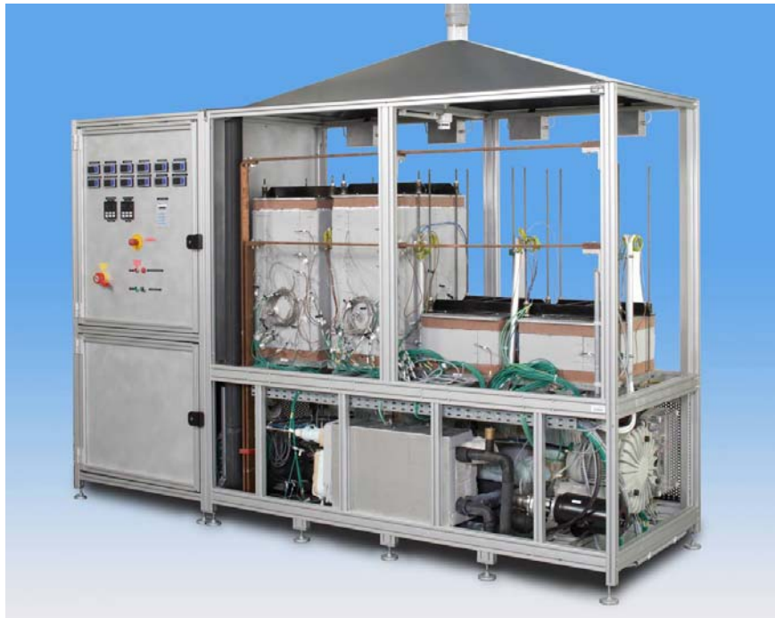
Abb. 7: 20 kW SOFC-Anlage mit zwei montierten integrierten Modulen
