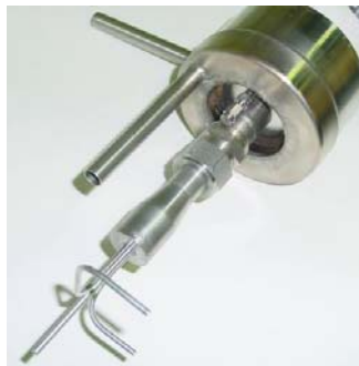
Abb. 67: Mischkammer-Oberteil des Reaktors ATR-6B mit gekühltem Düsenstock
