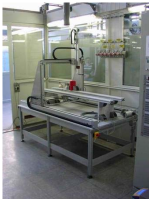
Abb. 48: Magnetotomograph basierend auf einem Verfahrtisch und zwei Magnetsensoren (Honeywell HMC 1063)
