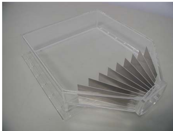
Bild 4.32: Verteilerhaube für eine Push-Anordnung (Abmaße: 35 x 28 x 8 cm)
