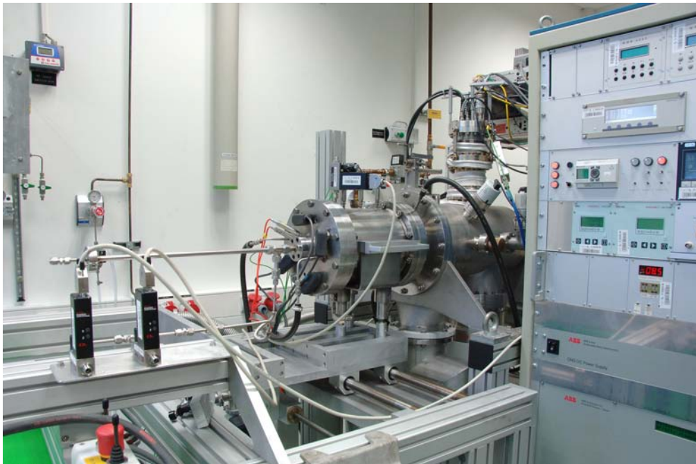
Abb. 6.23: An das HDMS angeflanschter Druckofen
