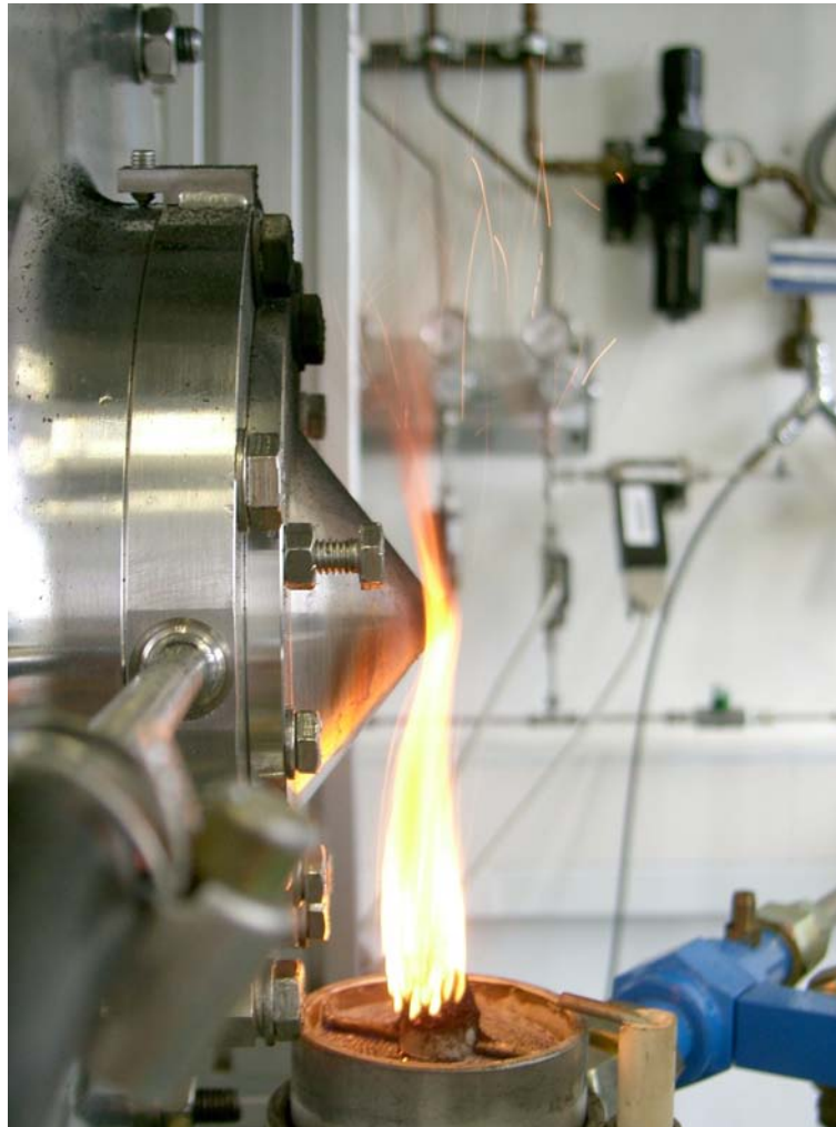
Abb. 6.20: Verbrennung von Kohle im Flachflambrenner
