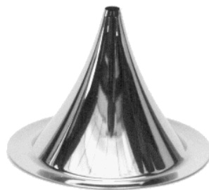
Abb. 5.7: Im HDMS benutzter Skimmer von Beam Dynamics, Inc. [3]
