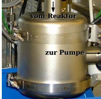
(a) Die Kühlfalle, eine Nor-Cal FTWA-6-1502-NWB
