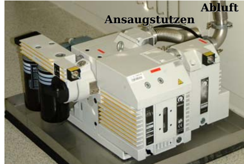
(b) Die Vakuumpumpe, eine Leybold Trivac D40 BCS PFPE
