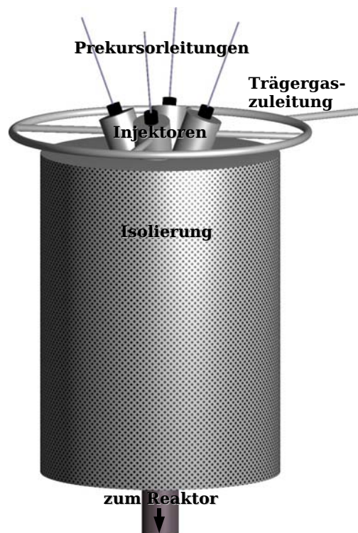
Abbildung 3.3.: Der Verdampfer (TriJet®) in einer schematischen Zeichnung. Der Prekursor gelangt über vier separate Leitungen zu den vier Injektoren, die wassergekühlt sind und an der Spitze vom auf 200 °C erwärmten Trärgas umspült werden. Horizontal ist das heiße Rohr, welches zum Reaktor führt, thermisch isoliert.
