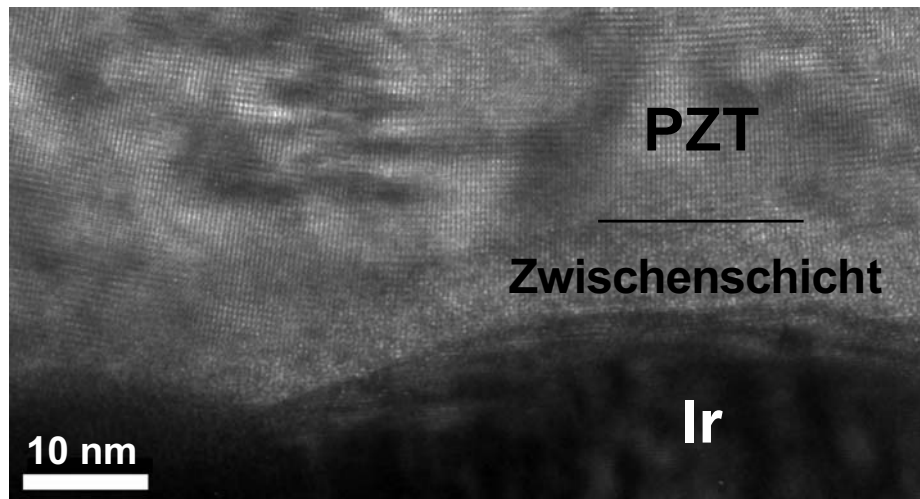
Abbildung 5.3.: Bild einer hochauflösenden Transmissionselektronenmikroskopie (HR-TEM) der polykristallinen PZT(60/40)-Schicht auf Ir. Man erkennt drei übereinanderliegende Bereiche.
