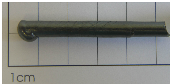
Abbildung 11: Bild des \text{TbMnO}_3 -Einkristalls nach der Zucht
