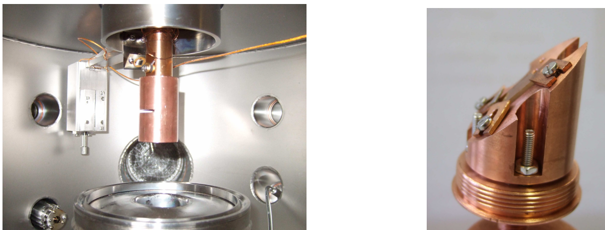
Abbildung 4.14.: Links: Innenansicht der Alice-Kammer mit Probenhalter am Kaltfinger des Kryostaten befestigt und Detektor. Rechts: Probenhalter mit aufgebrachtener Probe 7125.
