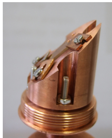
Abbildung 4.14.: Links: Innenansicht der Alice-Kammer mit Probenhalter am Kaltfinger des Kryostaten befestigt und Detektor. Rechts: Probenhalter mit aufgebrachtener Probe 7125.
