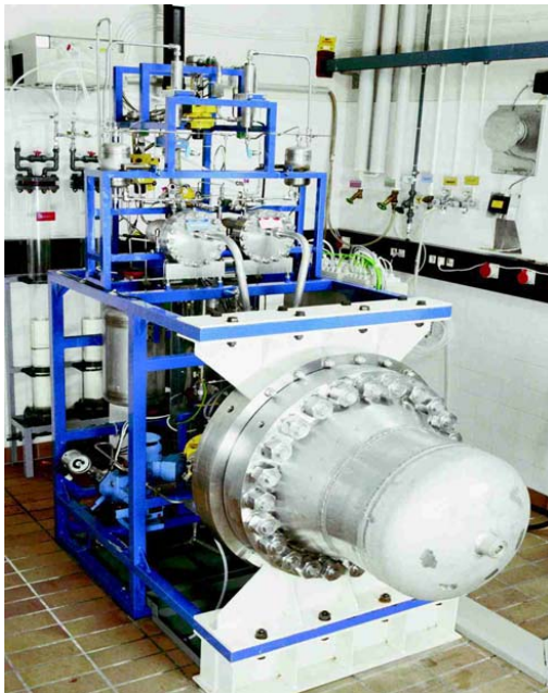
Abbildung 7: Alkalischer 120-bar-Elektrolyseur, technische Spezifikation
