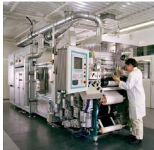
Abbildung 6: Maschinelle Herstellung von Gasdiffusionselektroden (links) und Robotersystem zur Herstellung von MEAs und stanzttechnisch hergestellten Stackkomponenten (rechts)
