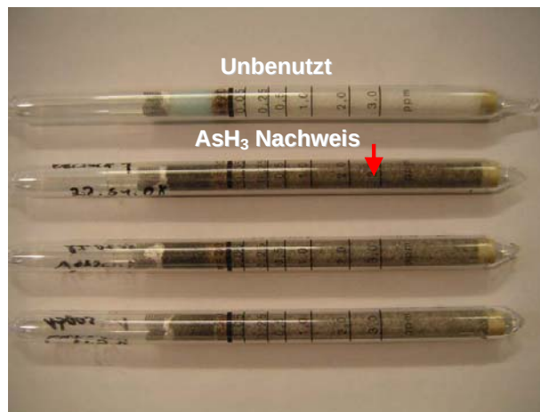
Abbildung 8: Prüfröhrchen zur Bestimmung von Arsenwasserstoff in Abgasen
