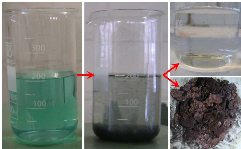
Abbildung 3: Hintergrund und Ziel der Elektrokoagulation
