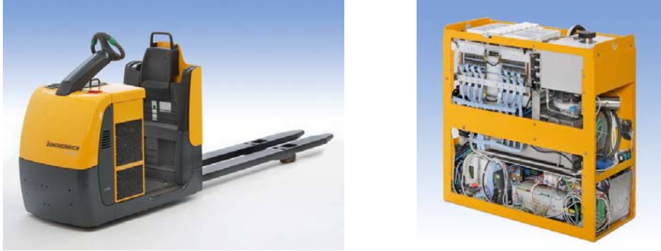
Abbildung 10: Konzeptstudie einer Direktmethanol-Brennstoffzelle in einem Flurförderfahrzeug (Horizontal-Kommissionierer der Firma Jungheinrich mit DMFC-Energiesystem V3.1, Forschungszentrum Jülich)
