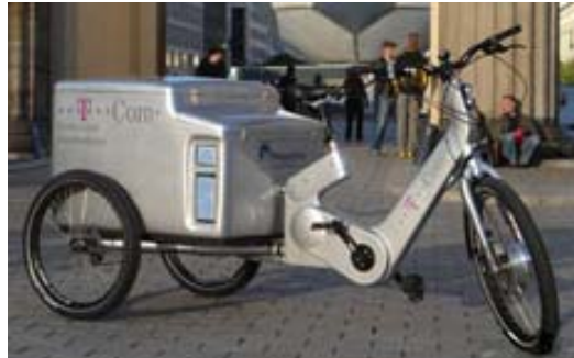
Abbildung 8: Das Cargobike, ein Lastenfahrzeug mit Brennstoffzellenunterstützung und Wasserstoff als Kraftstoff als Beispiel für innovative Transportkonzepte
