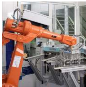
Abbildung 6: Maschinelle Herstellung von Gasdiffusionselektroden (links) und Robotersystem zur Herstellung von MEAs und stanzttechnisch hergestellten Stackkomponenten (rechts)
