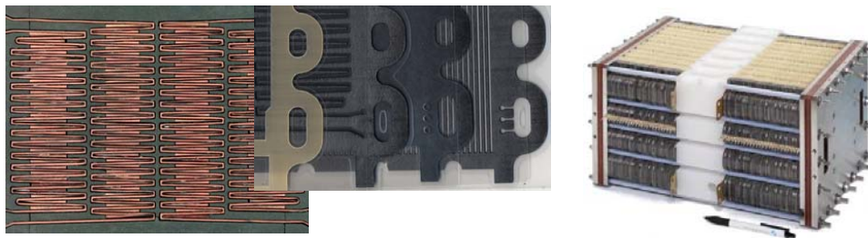
Abbildung 7: Stanztechnisch hergestellte Stackkomponenten (links) und DMFC-Stack (rechts)
