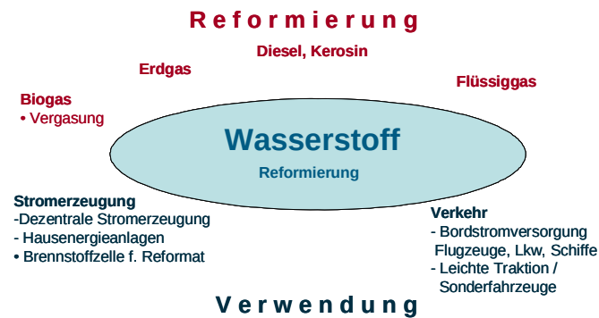
Abbildung 10: Wasserstoff aus kohlenstoffhaltigen Energieträgern (short-lived hydrogen)
